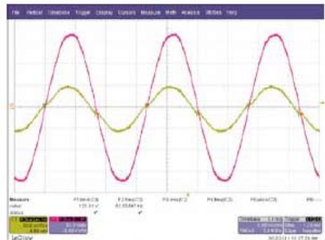
図2：主電源の電圧と電流 (PFCのある場合) (CP-800)
